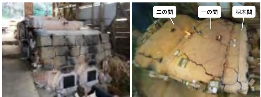
図 2 窯本体の外観 左:正面 右:上面
