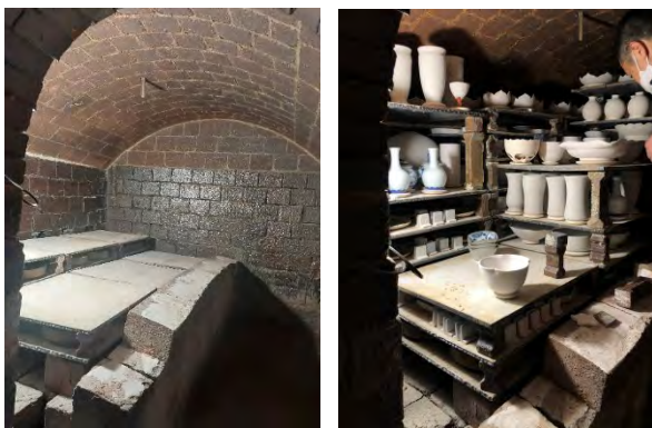
図3 窯内部及び窯積みの様子
