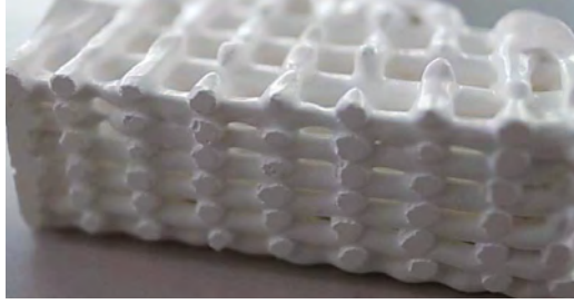
図 16 アルミナ焼結体の断面画像
