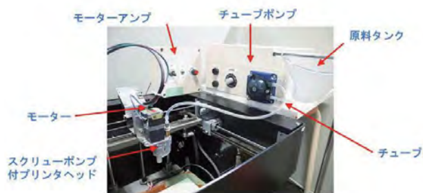
図1 試作した3Dプリンタシステム
