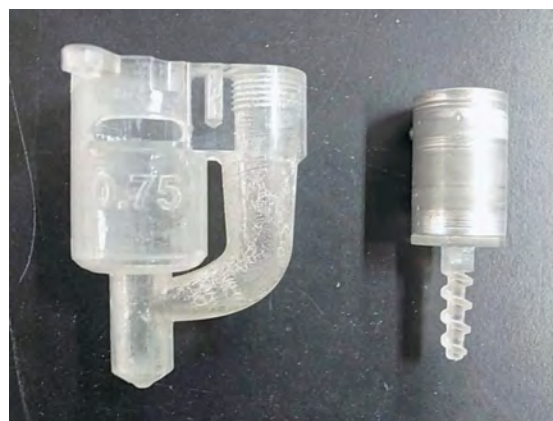
図8 プリンタヘッドの構成パーツ
