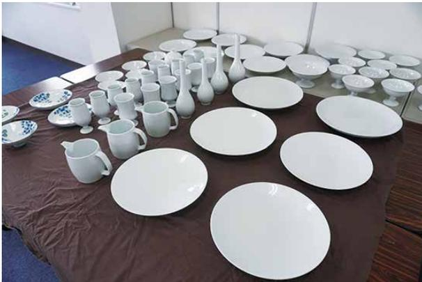
図4 配合陶土による成形試験後焼成品
