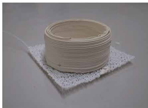
図9 3Dプリンタで積層した造形物
