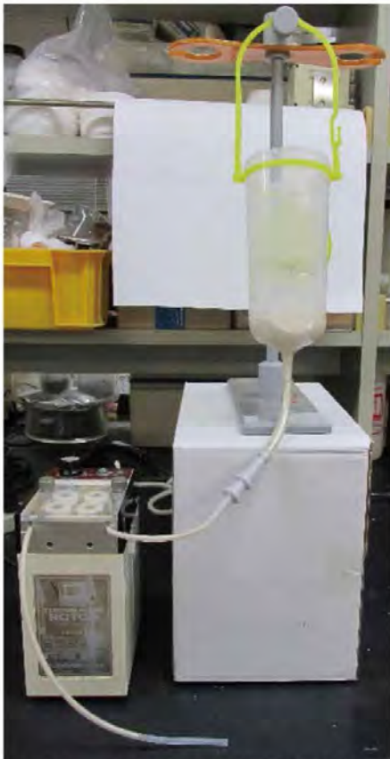
図 2 陶土の積層試験装置
