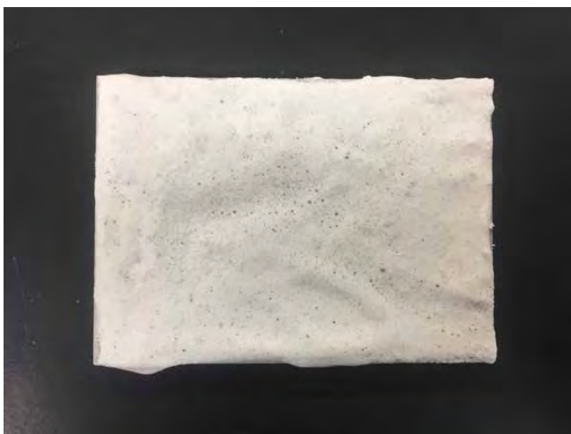
図4 ポリ乳酸とセルベンの複合塗膜 (3本ローラー/刷毛塗り)
