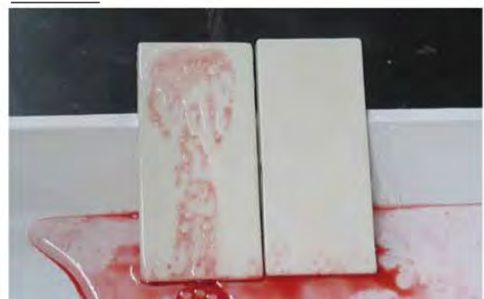
図 3 着色した食用油の流水による洗浄試験
