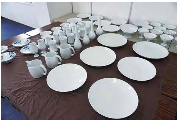
図4 配合陶土による成形試験後焼成品
