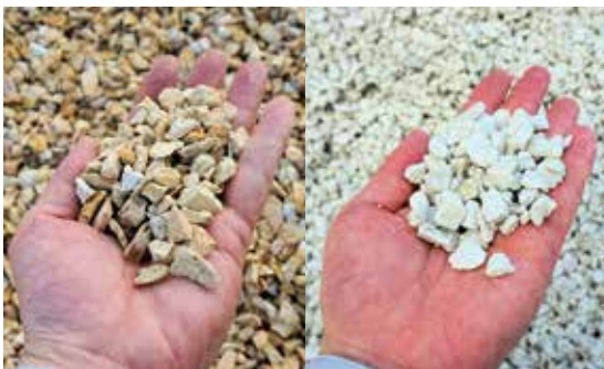
図1 塩酸処理による低品位陶石の色の変化 (左：処理前 右：処理後の脱鉄陶石)
