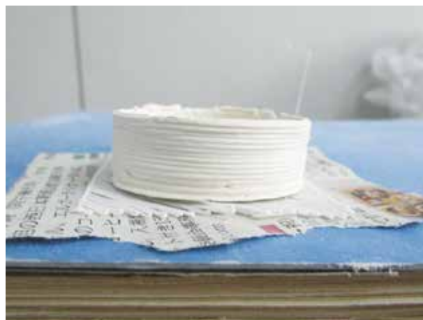
図3 3Dプリンタによる筒形の積層造形物
