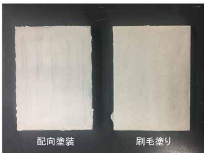
図8 ポリカプロラク톤とタルクの複合塗膜 (ボールミル/配向塗装および刷毛塗り)
