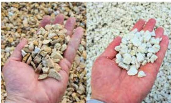
図1 塩酸処理による低品位陶石の色の変化
