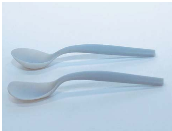
図7 ABS樹脂で試作したスプーン
