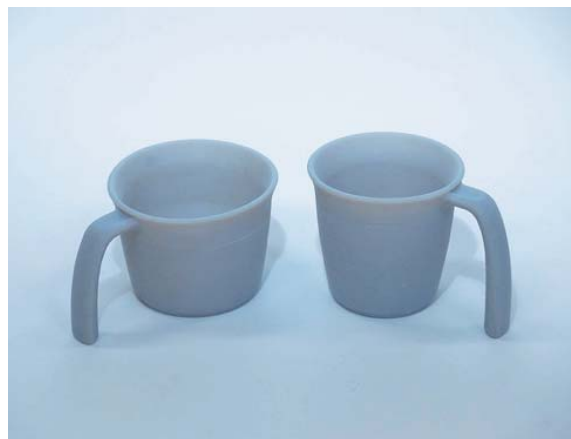
図7 ABS樹脂で試作したマグカップ
