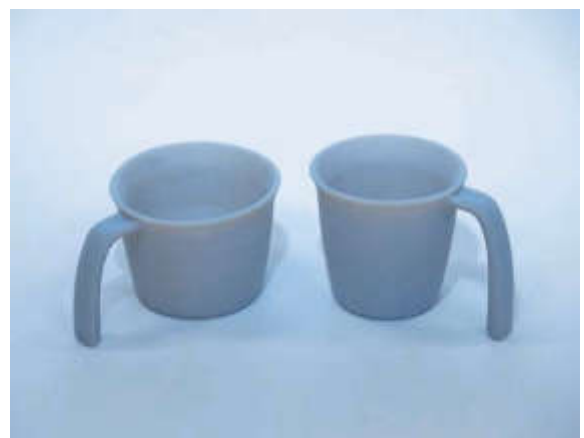
図7 ABS樹脂で試作したマグカップ
