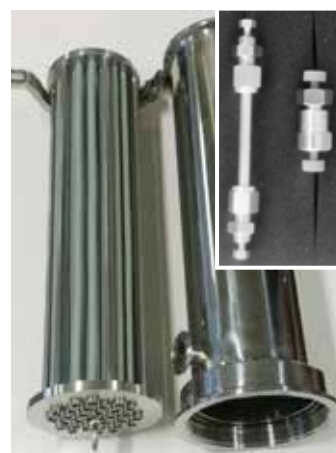
図3 ムライト質多孔体による精密ろ過フィルター及び液クロ用ラインフィルター(白枠内)
