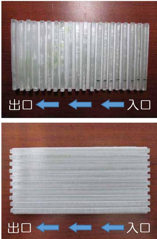
図3 循環水に対する成形体の設置方向
