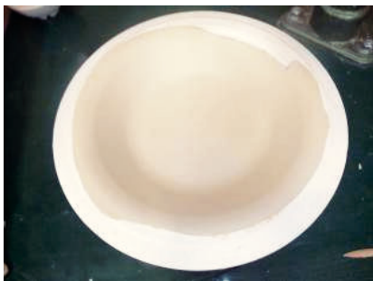
図11 陶土重量が285g未満で図成形した皿
