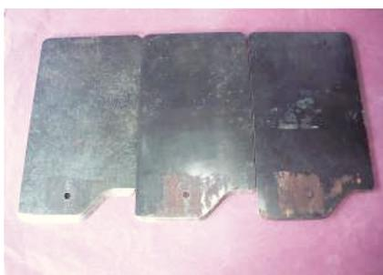
図3 成形試験用の3種類の「へら」
