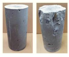
図8 フライアッシュ系ジオポリマーコンクリート (左) と圧縮試験後(右)の様子の一例 配合組成;単位水量=190kg/m³, 硬化液/FA=0.7
