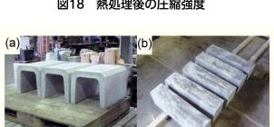
ジオポリマーコンクリート試作品 (a) U型側溝 (b)境界ブロック
