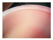
図12 陶土重量が310g以上で成形した皿(倍率5倍)
