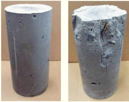
図8 フライアッシュ系ジオポリマーコンクリート(左)と圧縮試験後(右)の様子の一例
