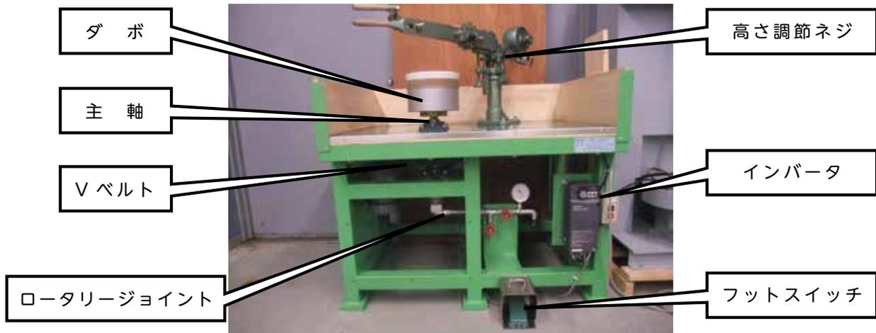
図5 試作した機械ろくろ成形装置
