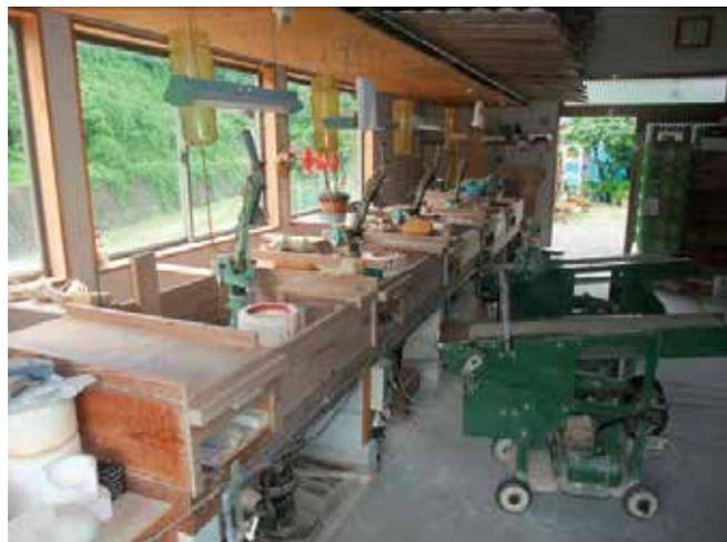
図1 機械ろくろ成形装置
