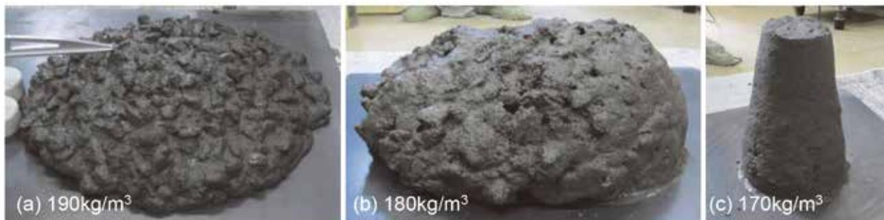
図2 フライアッシュ系ジオポリマーのスランプ試験後の様子
