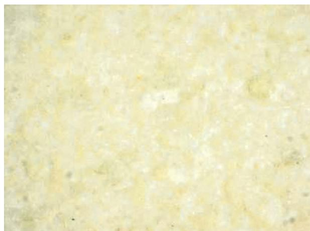
図7 温度差600°Cの熱衝撃試験後の試験体表面拡大写真 (×175)
