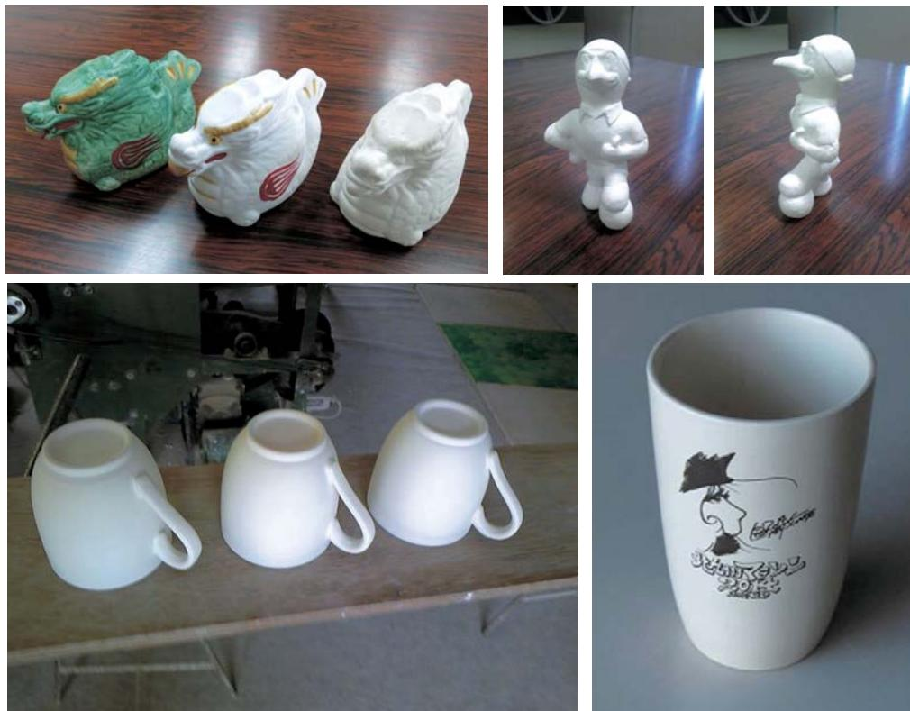
図4 低温固化陶土による試作
