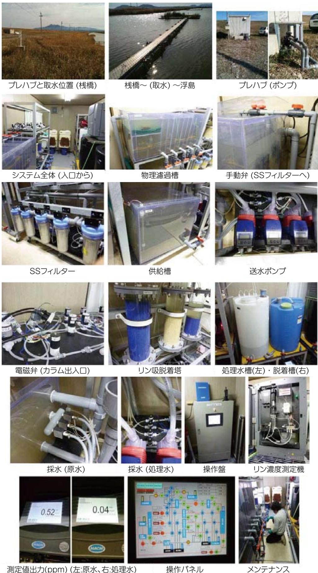
図5 リン吸脱着システム
