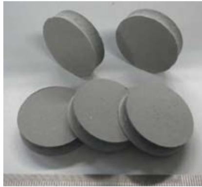
図12 プレス成型による多孔体の外観
