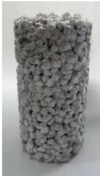
図14 粗大骨材を用いた多孔体の外観
