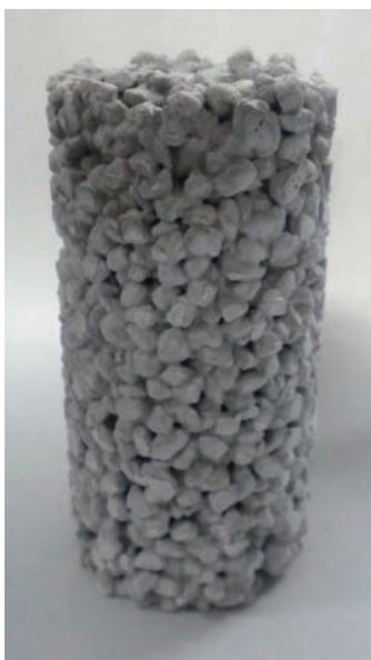
図14 粗大骨材を用いた多孔体の外観
