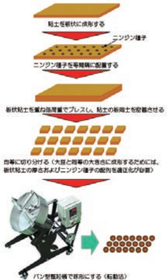
図1 量産を考慮したニンジン種子団粒化プロセス
