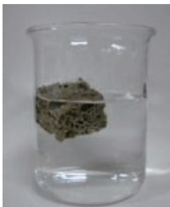
図5 Si発泡多孔体が水に浮く様子
