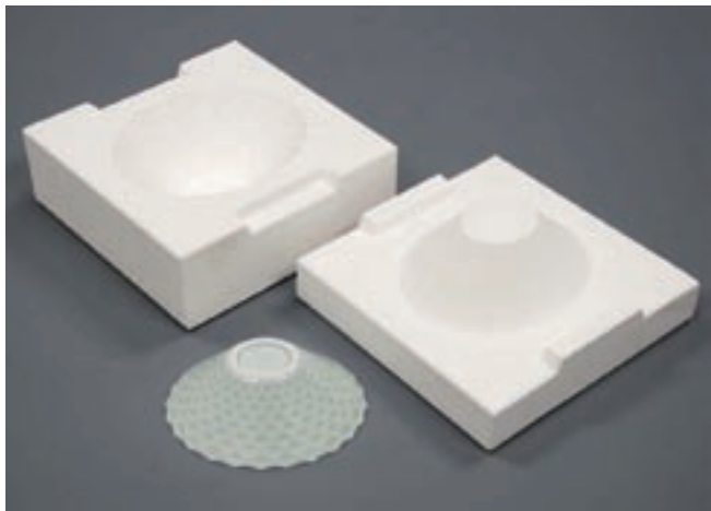
図12 直接加工した石膏型と製品
