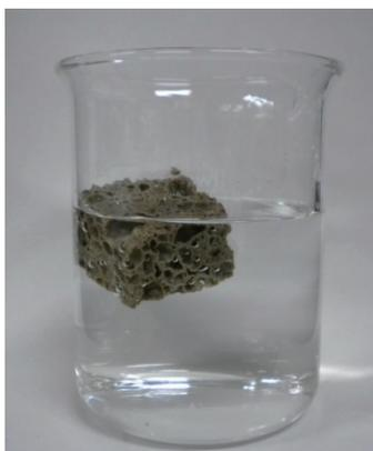
図5 Si発泡多孔体が水に浮く様子
