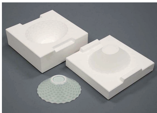
図12 直接加工した石膏型と製品
