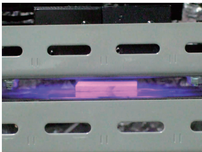
図3 光触媒活性の評価状況（紫外線照射）
