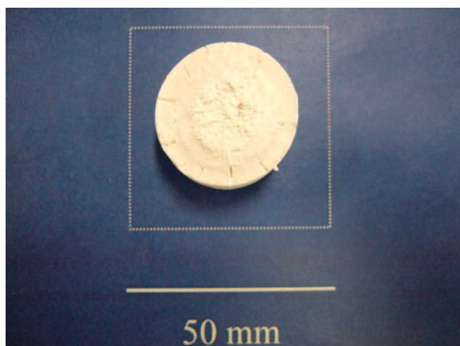
図7 常圧焼結後のソーダガラス－複合型光触媒系傾斜試料の状態（1000℃）
