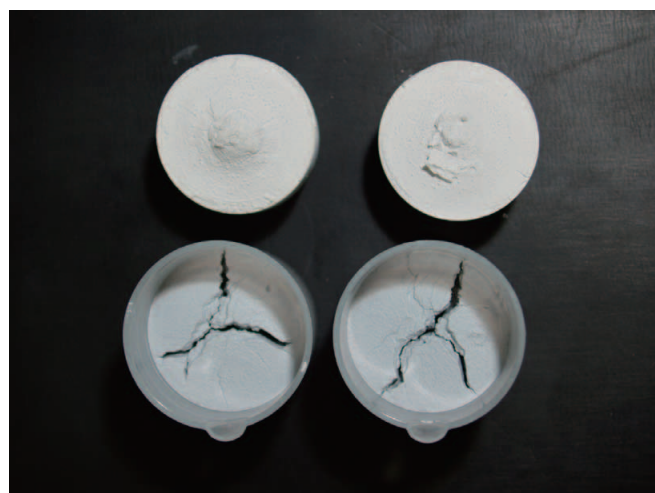
図5 乾燥方法の違いによる試料表面 (上段：凍結乾燥、下段：大気乾燥)
