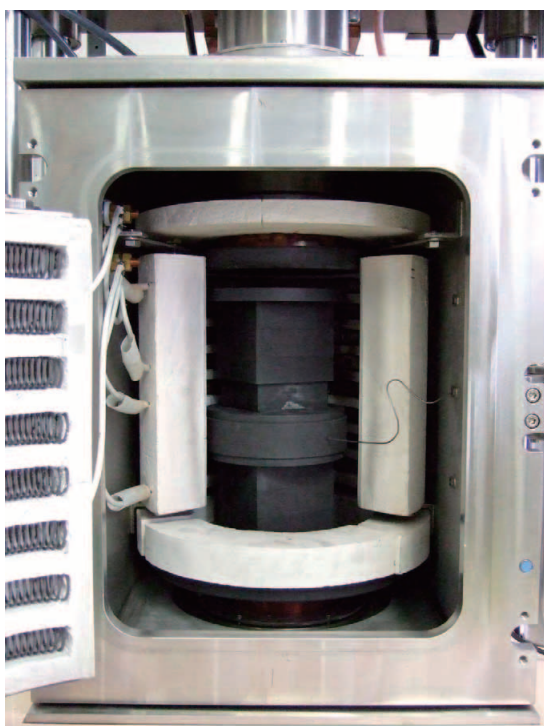
図1 放電プラズマ焼結装置内部
