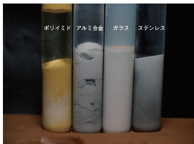
図4 各試料の遠心処理後の傾斜組織
