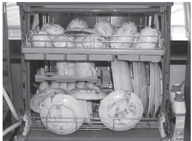
図4 洗浄、水抜け確認
