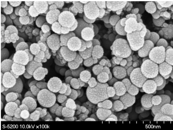
図6 非晶質シリカ微粒子の電子顕微鏡写真
