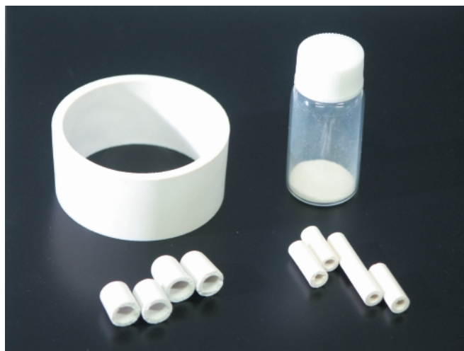
図4 試作品の一例 （粉末（右上）・押し出し成形品（右下）・鑄込み成形品（左上下））
