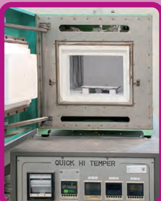
⑦ 高温電気炉 (1,600℃程度)
