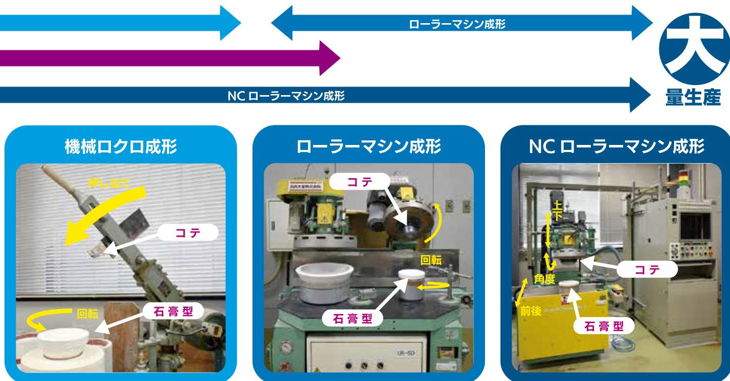
●回転台に石膏型をセットし、陶土を型内に置いて回転させ、金属製のコテを押し当てて成形します。
