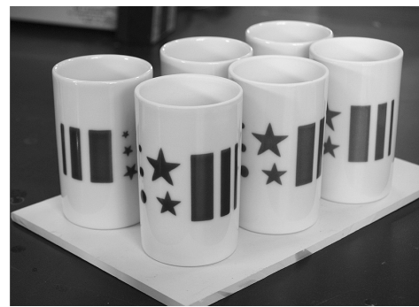
図2 生釉上へ転移（左：落剥 右：良好）
