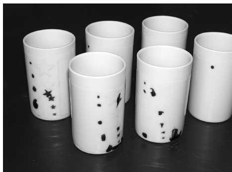
図2 生釉上へ転移（左：落剥 右：良好）
