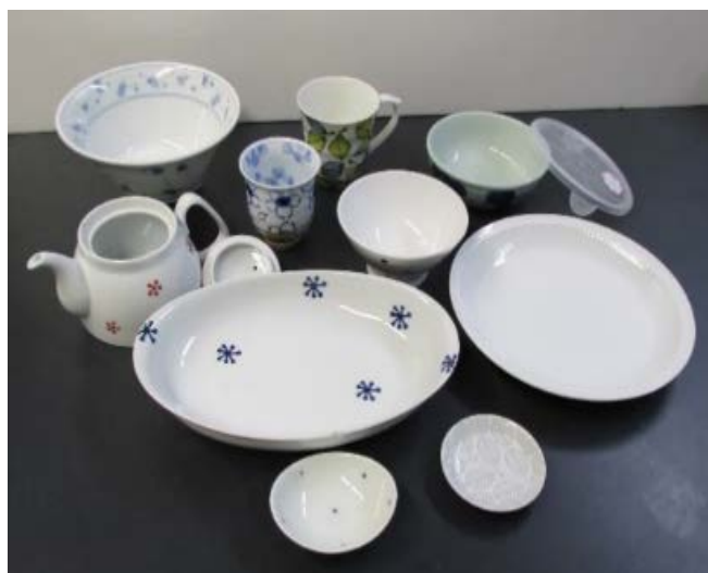
鉛の溶出試験をした波佐見焼製品
