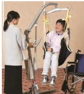
「移乗支援リフト」ベッドから車いすへの移動などを安全に行えます
