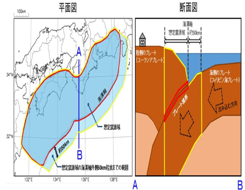
想定震源域内（科学的に想定される最大規模の南海トラフ地震の想定震源域（中央防災会議、2013））のプレート境界部（図中赤枠部）と監視領域（想定震源域内および想定震源域の海溝軸外側50km程度：図中黄枠部）
