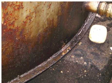
．重油タンクの腐食
