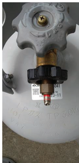
（中）高圧ホースがちぎれているが、張力式の高圧放出防止機構が作動している
