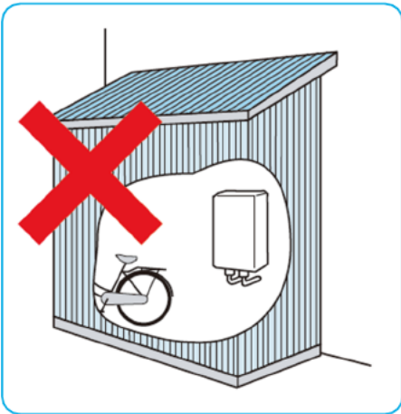
図4-18 屋外ガス機器は波板等で囲わないこと
