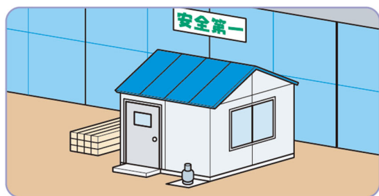
図5-4 工事事務所で8kg容器を使用の例
