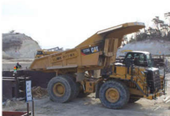
50tダンプ・30tダンプにより大量の土砂をベルトコンベアーの破砕搬入口へ運搬（写真は50tダンプ）
