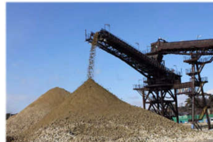
ベルトコンベアー（最終落とし口部分は旋回型）延長1,200m、幅1.8m
