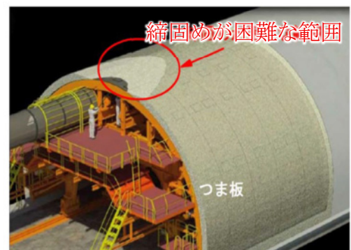
図10 天端部の打込み終盤時
