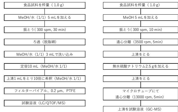
図1 定性用分析試料の調製法
