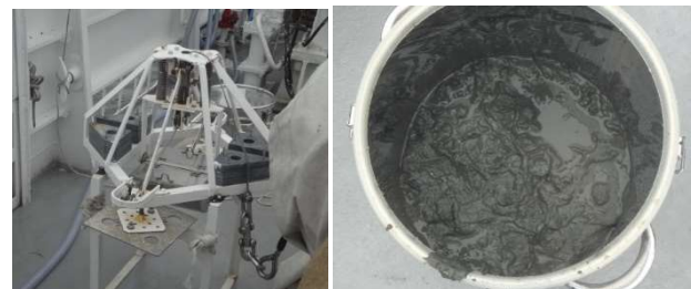
図4 スミスマッキンタイヤ採泥器(左)と採泥試料(右)
