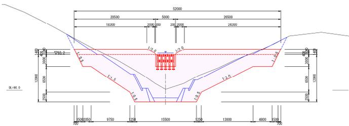
砂防堰堤側面図
