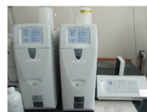
イオンクロマトグラフ装置
