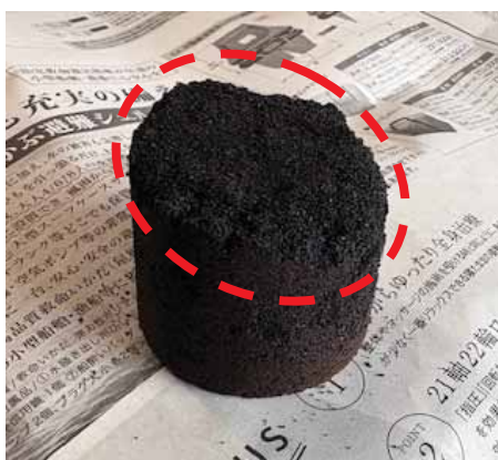
図5 試料(1)の成型砂(一部欠損)
