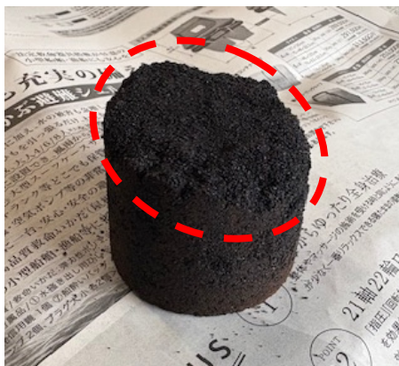
図5 試料(1)の成型砂(一部欠損)
