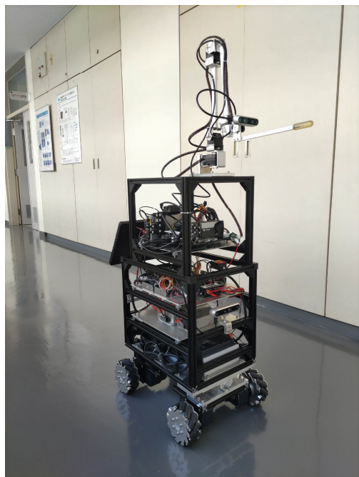
独自設計したニューラルネットワークで制御されるアーム付き移動ロボット
