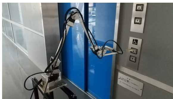
独自設計したニューラルネットワークで制御されるアーム付き移動ロボット
