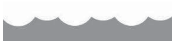
図 1 各切れ刃の形状が不揃いな工具による加工面のイメージ
