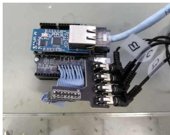
図 1 5 マイコンボード (SPRESENS)
