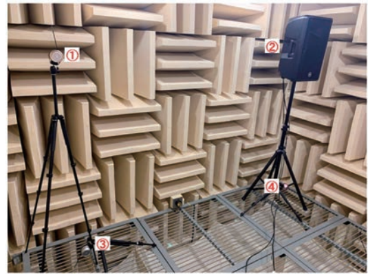
図6 データ取得時の音源配置(対象音抽出)
