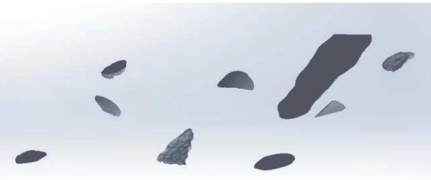
図7 破損部修復形状の3DCADデータ
