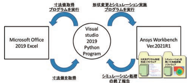
図4 3次元デジタル形状作成ソフトウェアとシミュレーションを用いた性能評価ソフトウェアを組合せたシステムのダイアグラム
