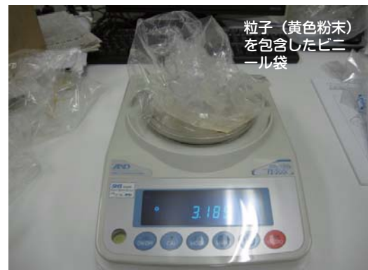
図7 粒子の噴出量測定
