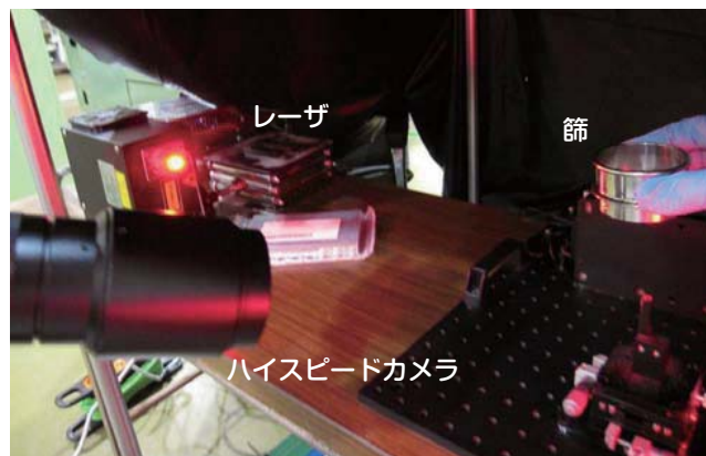
図3 終端速度の測定実験
