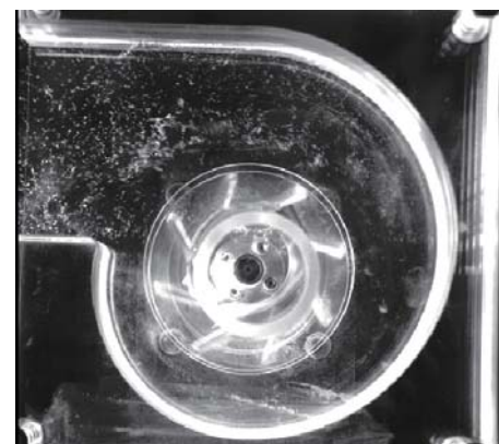
図9 送風機（模型）内部の粒子挙動
