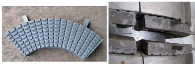
図8 冷金 - 鋳造品 (左)、木型への冷金装着 (右)
