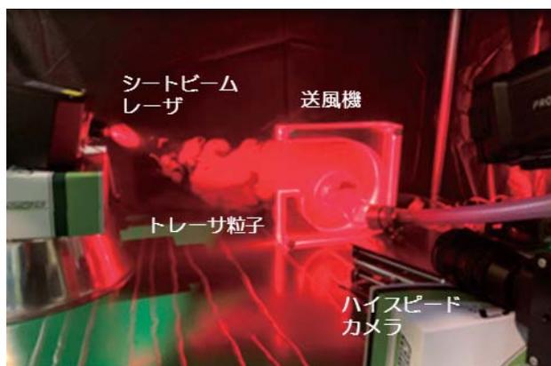
図2 可視化システムを用いた実験
