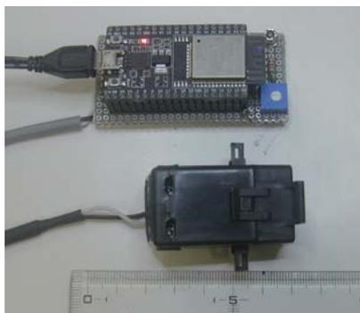
図7 電流用無線監視モジュール
