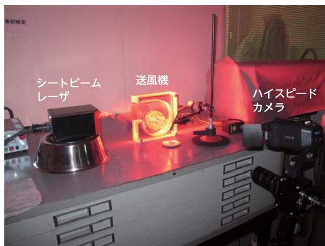
図2 可視化システムを用いた実験
